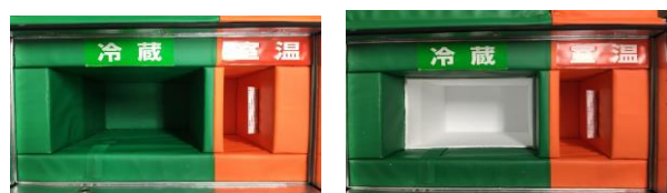
(a)断熱材無し (b)断熱材有り 図1 検体輸送用コンテナ
