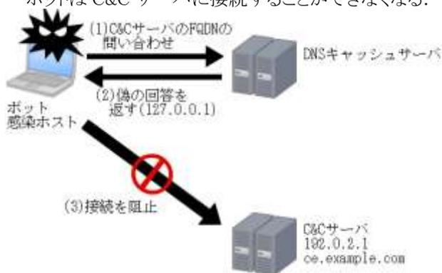
図 1. DNS シンクホールによる C&C サーバとボットの接続阻止の流れ
