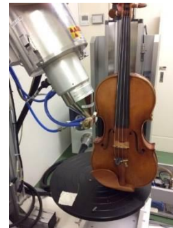
図 2: CT スキャンによる「魂柱」、「駒」の位置測定
