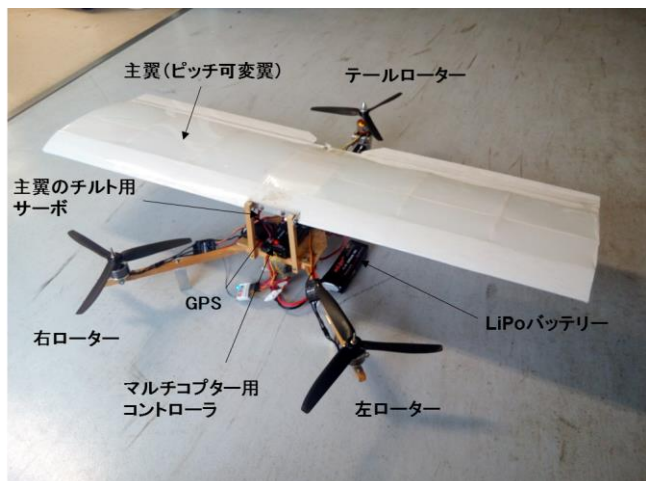
図1 試作した垂直離着陸機
