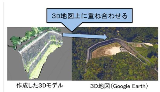
図 2: 3 次元形状データの 3D 地図上での表示イメージ
