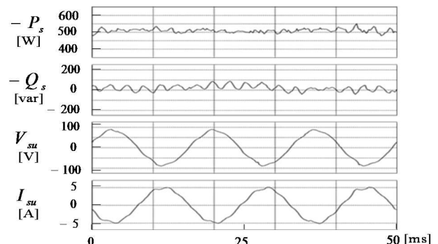
図6 電力脈動抑制制御ありの場合の実験波形
